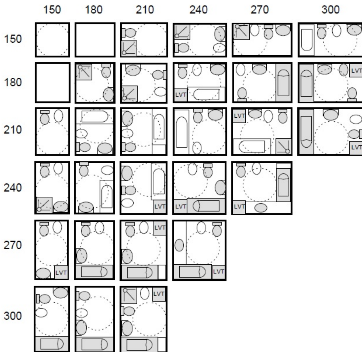
Figura 13 - Possibili schemi per servizi igienici (Fonte: Progettare la normalità – Schede tecniche per una progettazione senza barriere – Regione Emilia Romagna)
